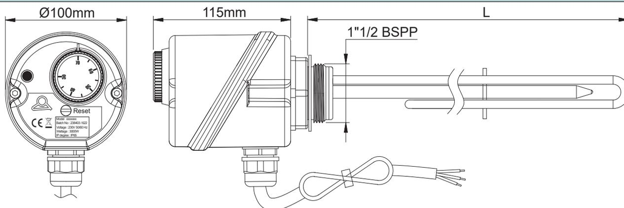
Riscaldatore unipolare 230V
