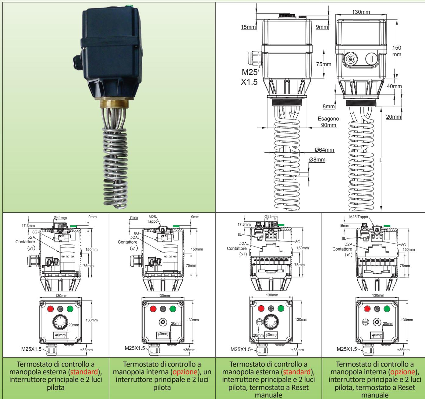
**Applicazioni principali :** Riscaldamento industriale di liquidi, circuiti di acqua calda, contenitori e serbatoi tampone, **in applicazioni in cui la lunghezza immersa degli elementi riscaldanti deve essere la più breve possibile.**
