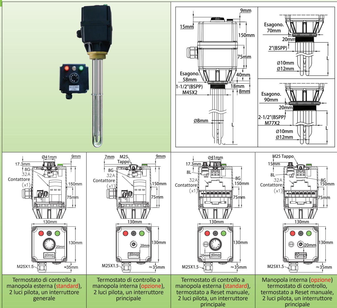
**Applicazioni principali :** Riscaldamento di liquidi industriali, circuiti di acqua calda, contenitori e serbatoi tampone. Questi riscaldatori a immersione sono progettati per applicazioni di media potenza, che richiedono relè di potenza. Sono dotati di un relè, 3 poli, 32A res. Hanno di serie due luci pilota e un interruttore generale. Sono destinati all'uso interno.
