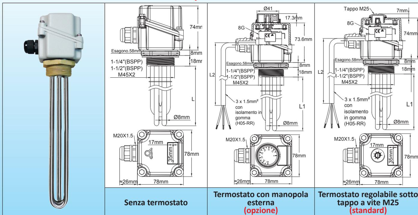
**Applicazioni principali:** riscaldamento di liquidi, circuiti di acqua calda, contenitori e serbatoi tampone.
