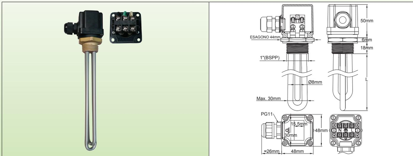
**Applicazioni principali:** riscaldamento di liquidi, circuiti di acqua calda, contenitori e serbatoi tampone. Dispone di 2 elementi riscaldanti dia. 8 mm, 230V, collegati in parallelo. Il collegamento seriale di questi elementi consente di utilizzarli a 115V.
